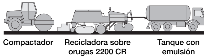
Fig 2.3 Tren típico de reciclaje con emulsión asfáltica usando una máquina montada sobre orugas
